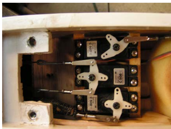
Her ses nederst stødstang af balsa til højderor, i midten wiretræk til sideroret og øverst metalkabel til motordrossel (Acro Wot fra Chris Foss Design)
